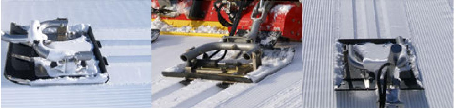
Die Anforderungen bei der Langlaufloipen-Präparierung sind sehr vielfältig. Präparieren Sie Loipen für den Leistungssport oder für den Breitensport? Mit unseren Varianten können Sie Loipen mit einer Spur links oder rechts bis hin zu vier parallelen Spuren präparieren. Die Schneefräse lockert den Schnee, zerkleinert das Eis und verfestigt die Schneedecke neu.
